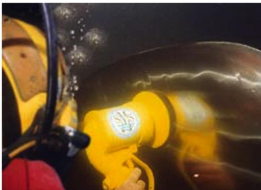
Fig. 30 - Polimento subaquático (in-water) do hélice
