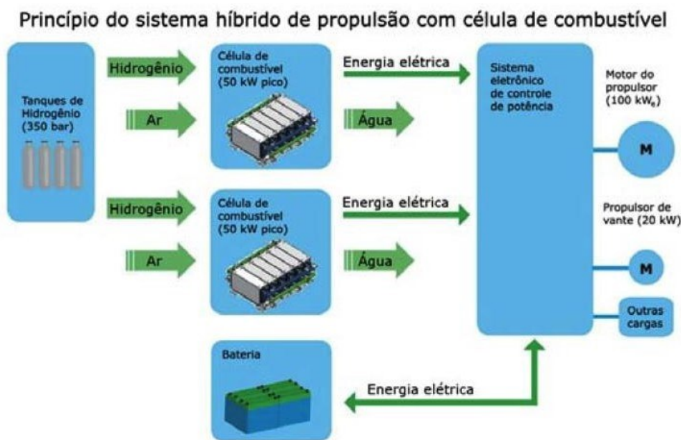
Fig. 30 - Esquema do sistema híbrido do navio ZemShip
