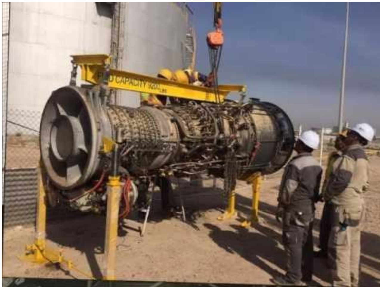
Fig. 26 - Turbina a gás General Electric Modelo LM2500 utilizada a bordo de navios (Ver tamanho comparativamente com o homem)
