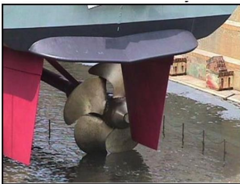
Fig. 28 - Ilustração de flap de popa
