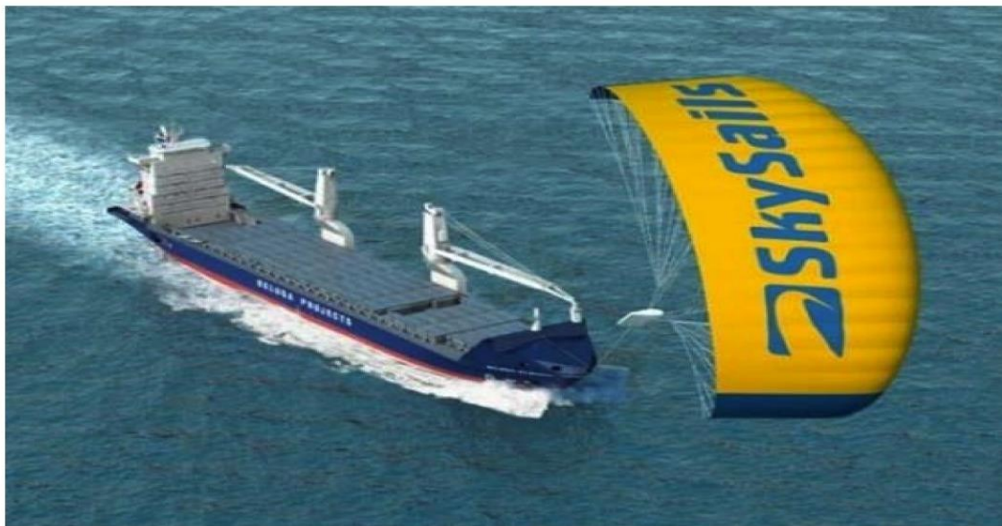
Fig. 34 - Navio Beluga equipado com Kite (Fonte: Sky Sails)
